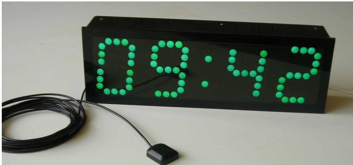
Индикатор предназначен для установки в щиты управления. Изготавливается с размерами корпуса кратными размерам ячеек щита - 24 мм, 25 мм, 40 мм и др. Синхронизация времени при необходимости может осуществляться от системы глобального позиционирования (GPS) или от компьютера через различные интерфейсы (RS-485, RS-232, Ethernet). Индикатор также может служить источником сигналов синхронизации для других устройств.
