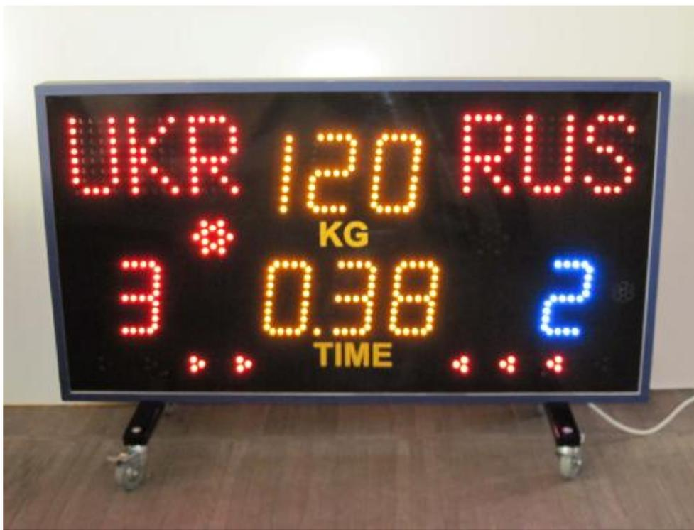
Табло предназначено для использования в помещениях при обслуживании соревнований по классической борьбе. Варианты исполнения могут быть – напольный передвижной (на колесах) либо настенный. Связь с Пультom управления – проводная (4-хжильный кабель) или беспроводная (радиоканал на разрешенных в Украине частотах).
